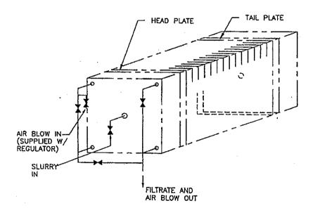
Fig. 4-14. Air Blow Down Manifold Diagram
