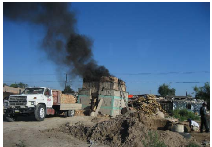
Tradicional horno ladrillero quemando material de desecho cerca de casas y comercios en Ciudad Juárez, México. ©Paul Ganster
