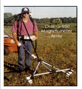
Figure 4-1. Hand-Held Magnetometer
