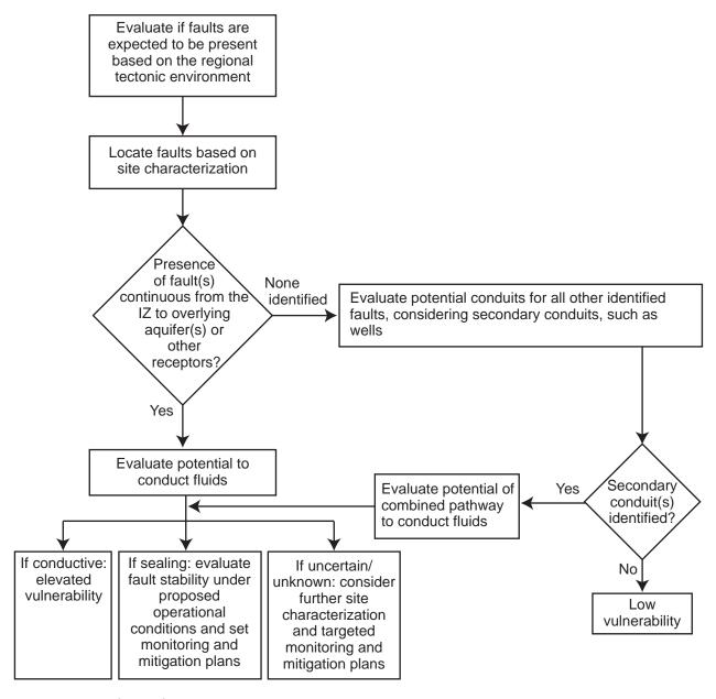
Figure 5.3. Faults Evaluation
