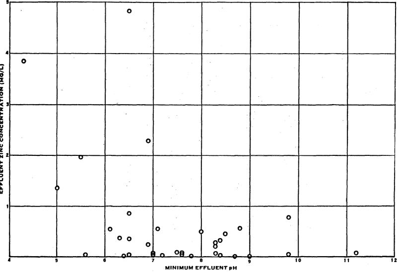
FIGURE VII-3. EFFLUENT ZINC CONCENTRATION VS. MINIMUM EFFLUENT pH
