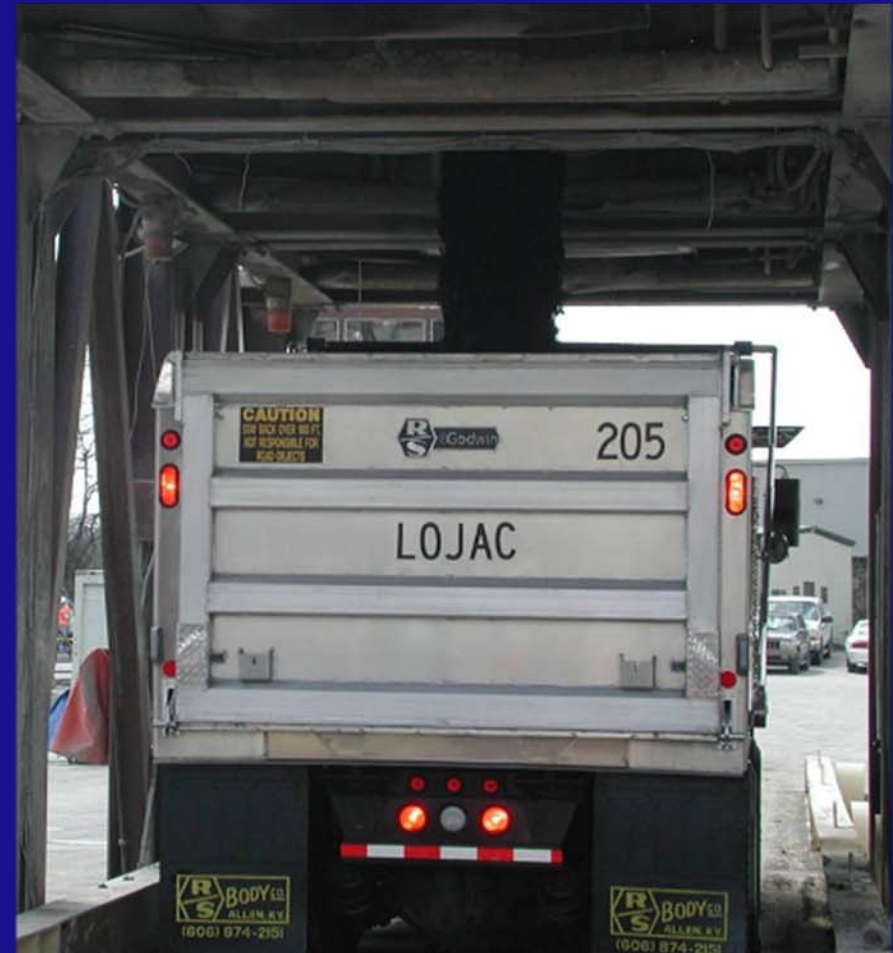
Warm Mix Asphalt 250°F
